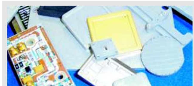
圖二：集成電路中的金屬復合材料封裝基板及散熱件
