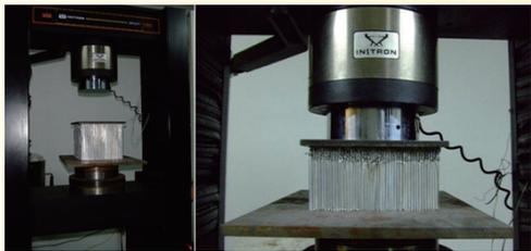
圖 6 鋁蜂窩緩衝器的准靜態壓縮試驗
