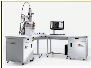
圖二，電子顯微鏡大小的桌上微型電子束焊接設備
