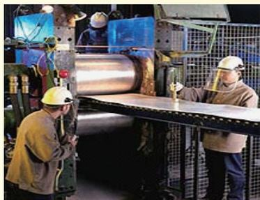
圖 .15 CSIRO 已經開發出試驗工廠，用於生產工業用途的鎂合金片材
