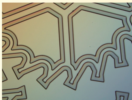
(a) 機械機芯擒縱輪的微結構
