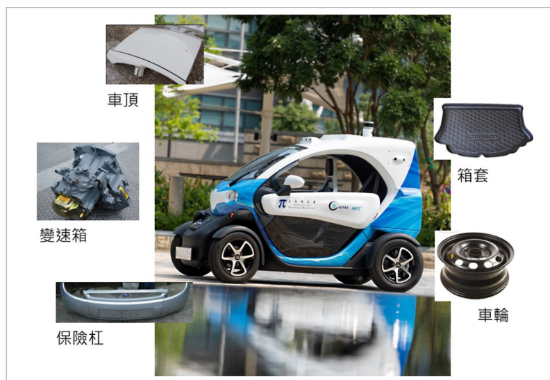
圖四：夾層金屬及塑膠／纖維板材的汽車應用
