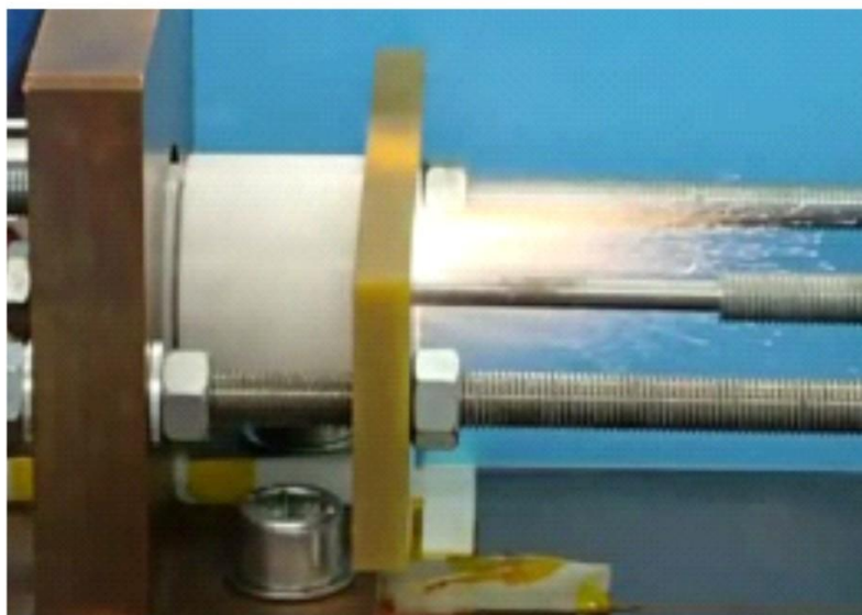
電磁脈衝接合技術利用強大磁場和沖力令工件變形並接合
