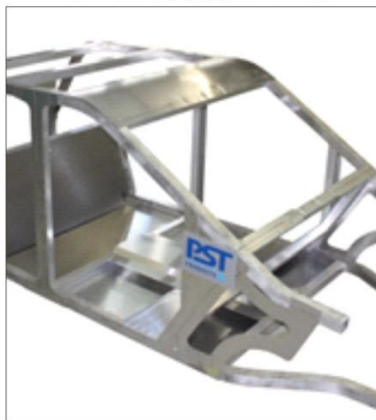
電磁脈衝接合技術可用于連接車身不同物料的金屬部件
