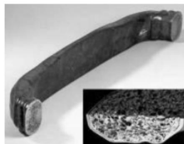
金屬密閉泡沫因為抗折彎能力高，可用于防護物料。
