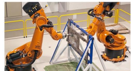
圖4：兩台機器人增量成形技術設備工作平台（來源：Blechbearbeitung im Roboforming Verfahren mit Zahnradpumpen zur Schmierölversorgung）
