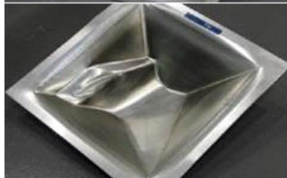
圖7：利用機器人增量成形技術製作的汽車零部件（來源：Ford's Advanced Prototyping, Personalization and Low-Volume Production Technology）
