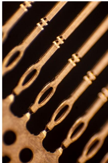
Press Fit無焊錫壓接技術，除可令產品組裝自動化外，也令使生產過程更節能及環保
