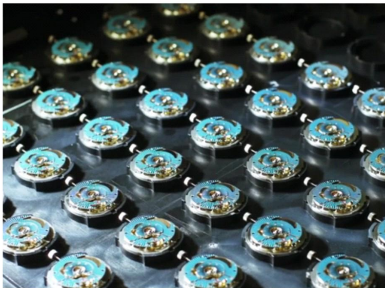
圖3: Sistem51機心應用數字印刷后的藍色表面（圖片來自 http://www.swatchgroup.com/en/group_profile/innovation_powerhouse/industry_4_0_overview/digital_printing_expertise_by_eta ）
