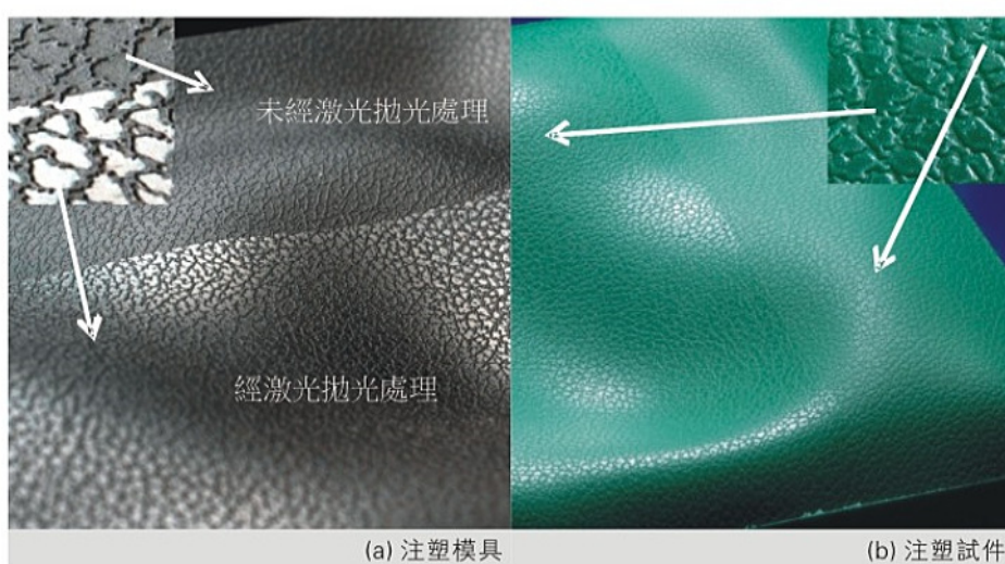
圖4：激光拋光皮紋模具（德國Fraunhofer ILT 提供）
