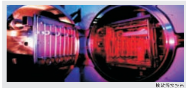
擴散焊接技術
