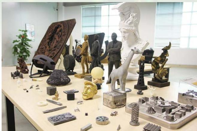
張威龍表示，現階段 3D 打印的發展往往是把傳統工藝和現代設備融合起來，而形成嶄新的生產模式。以製作銅像為例，首要步驟是先進行 3D 掃描，讀取有關數據，其後再配合 3D 打印設計軟件起圖和修正微細部位。經過 3D 打印出來的砂模會進行傳統工序，由師傅進行鑄造。
