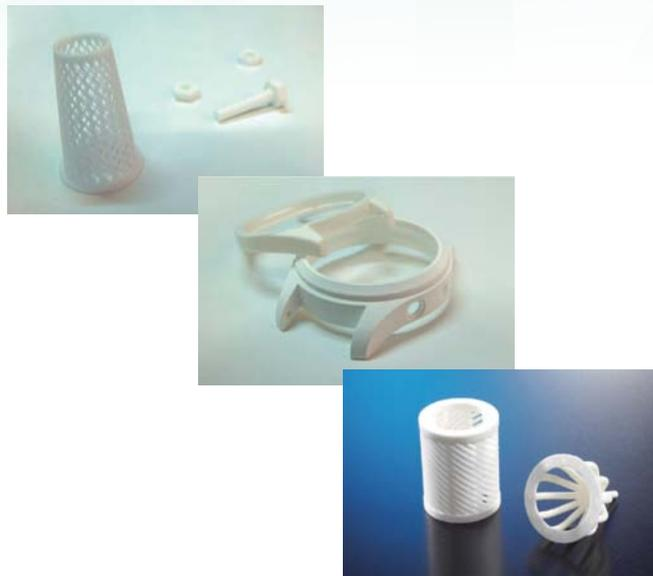
圖 4：高精度及表面光潔度的 3D 列印樣品
