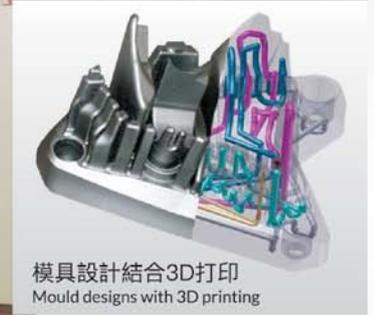
一般的模具製作對於隨形水路或結構複雜的零部件製作往往束手無策。「模具設計結合3D打印」概念，可節省打印時間及成本。此外，隨形水路模具零件能達致溫度平衡，生產週期會縮短，預防黏模，提升模具壽命。
