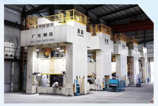
闭式双点压力机连线生产 配前移动工作台
