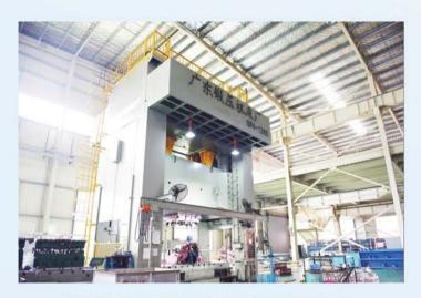
闭式四点压力机 配左右移动双工作台
