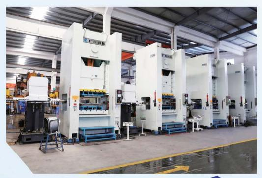
多机多站式自动转序生产线
