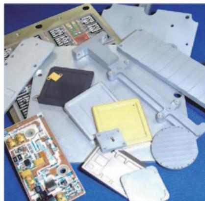
圖二：集成電路中的金屬複合材料封裝基板及散熱件
