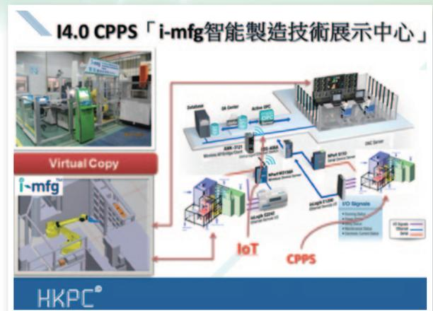
特色是採用「彈性製造技術 (Flexible Manufacturing Technology / FMT)」，建立智能及高度自動以至自主化的生產。FMT 是現代先進製造技術的統稱，集自動化技術、資訊科技和製作加工技術於一身，以往獨立進行的工程設計、製造、運作管理等工作，現在可利用軟件系統、資料庫及互聯網連接起來，覆蓋整個企業。i-mfg 透過一套智能自動及自主化模具製造系統，將模具的設計和製造工序整合、編排、優化、檢測、實時監控及調配，以進行彈性製造，快速生產不同規格和數量的零件，達致最少投資（使用最少設備，廠房面積最小）、最高生產效率（可以混合生產，無停機損失），以及最佳經濟效益（成本最低）的目標。
