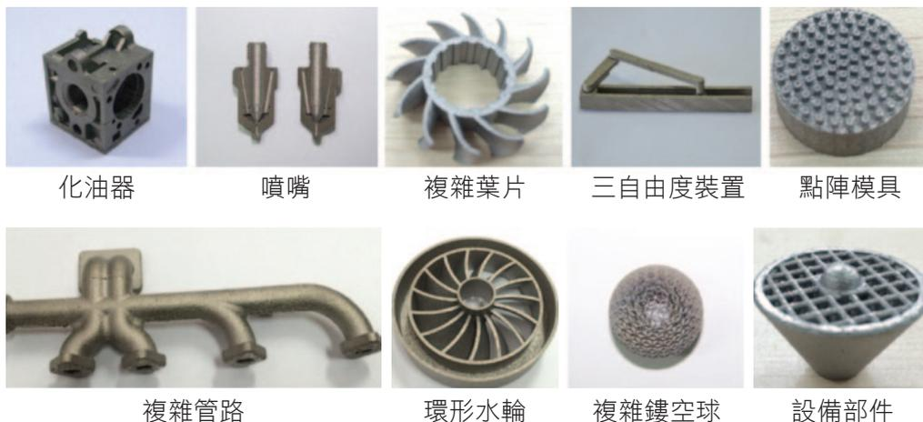
圖 5 SLM 複雜結構製造
