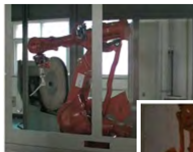
圖 4 國內機器人鑄件打磨系統應用
