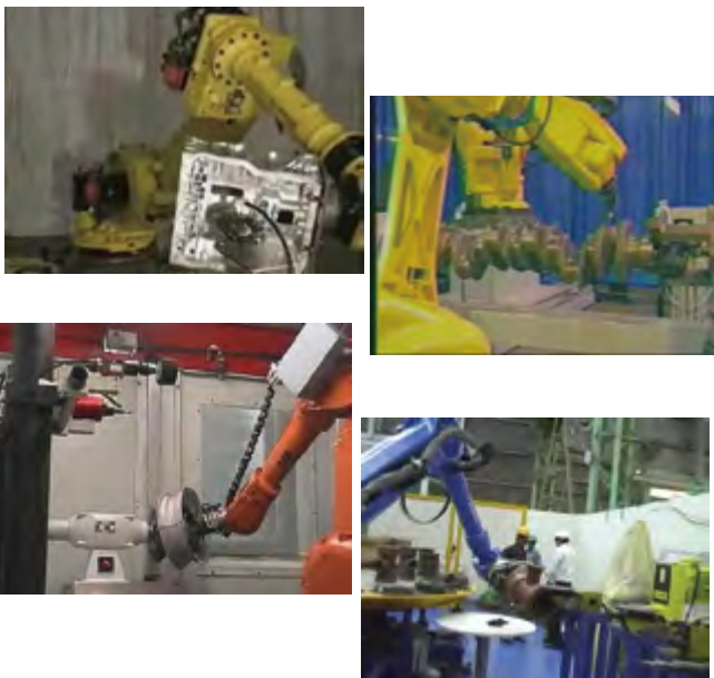
圖 3 國外機器人表面打磨拋光自動化的典型應用
