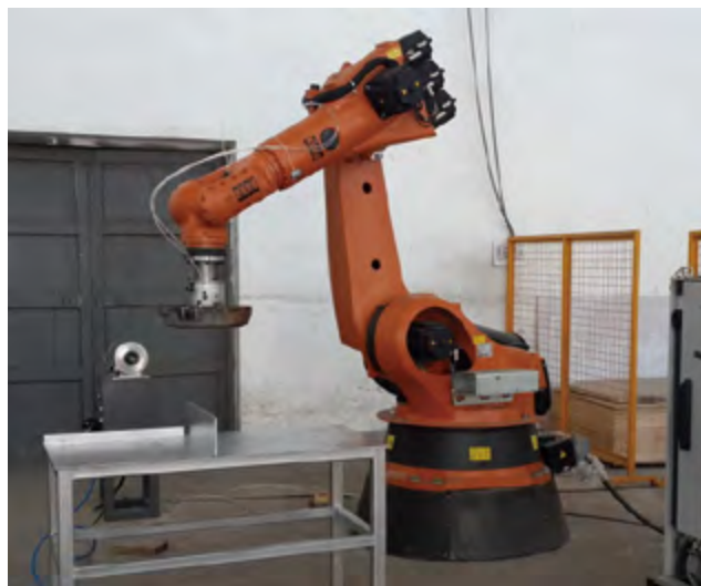
圖 5 精密工程研究中心研製的機器人鑄件打磨系統
