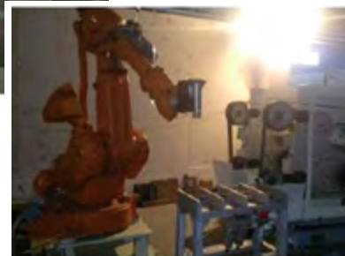
圖 4 國內機器人鑄件打磨系統應用
