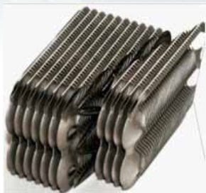
圖 2. 左：複雜的熱轉換汽車零件（源自 Eosint 公司） 中：鈦合金人體植入物（源自 Rainshaw 公司） 右：火箭引擎測試件（源自美國 NASA）
