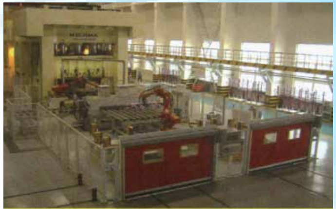
圖 2 大型機器人全自動化衝壓生產線（來源於中國機床網）
