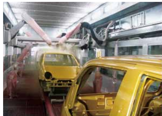
圖7 噴塗機器人（來源於數控機床市場網）
