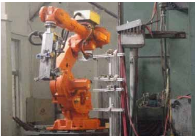
圖 3 3000T 壓鑄機的取鑄件機器人（來源於中國壓鑄網）
