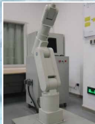
圖 9 我們研發的六軸工業機器人
