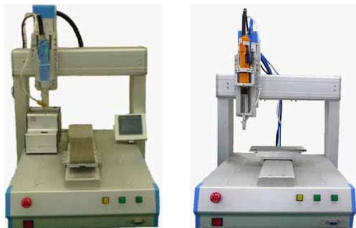
圖 10 我們研發的氣吸式自動鎖螺絲機和氣吹式自動鎖螺絲機
