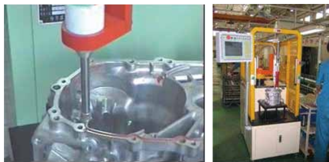
圖 11 基於 SCARA 結構的塗膠機器人
